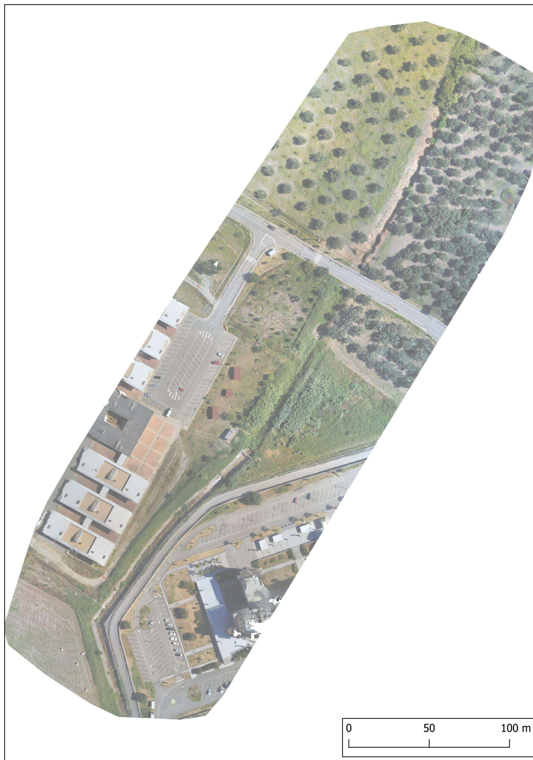
Fig. 14: Rilievo del corso d'acqua – ortofoto ottenuta con strumentazione drone
